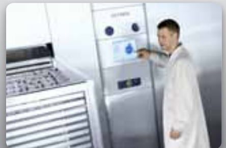
GEV TS Turbo är en autoklav för terminal sterilization och dess unika konstruktion och snabba process har varit en framgångsrik produktlansering för Life science segmentet.
