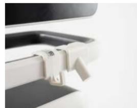
**Porte-accessoires à clipser** facilite le flux de travail du personnel de réanimation en proposant des supports pour les câbles et les outils nécessaires aux contrôles avant utilisation du ventilateur.
