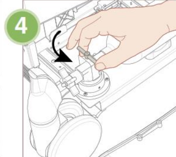
4 Desserrez lentement la clé en "T" en sens anti-horaire (un peu d'hélium résiduel va s'échapper)
