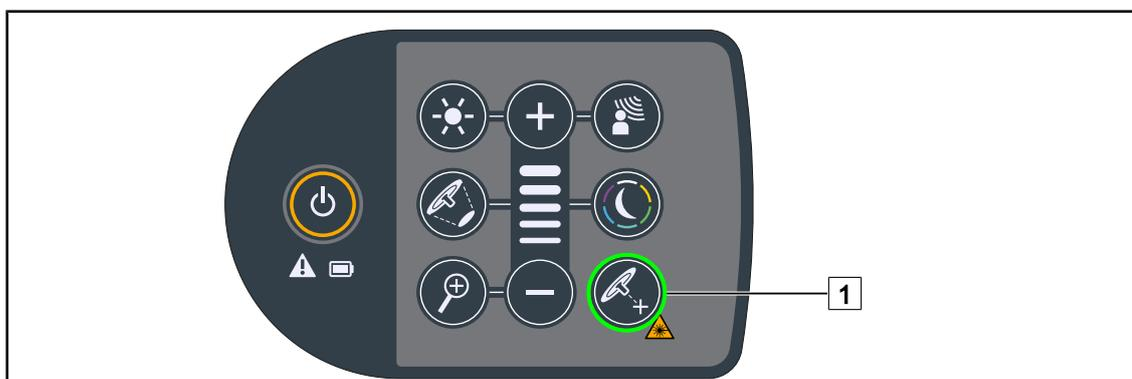
Fig. 65 : Activation du laser d'aide au positionnement via le clavier
