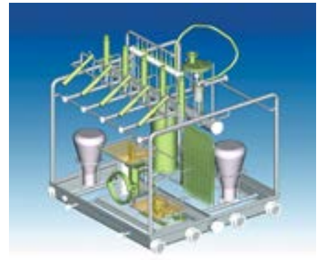
Für die Konstruktion maßgeschneiderter Beladewagen für verschiedene Anwendungen werden 3D-CAD-Modelle verwendet, meist in Kooperation mit dem Anwender oder Lieferanten der Ausrüstungen.
