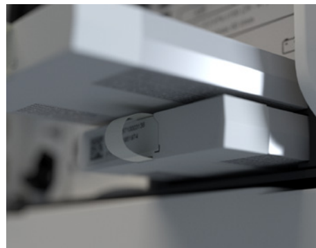
Zwei im laufenden Betrieb austauschbare Batterien mit insgesamt drei Stunden Laufzeit.
