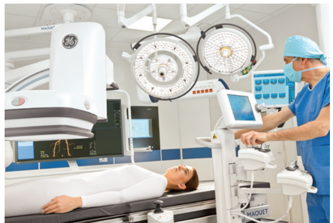
単一インターフェイスによる操作：Maquet Magnusの動作は、Discovery™ コントロールセンターで操作できます。
