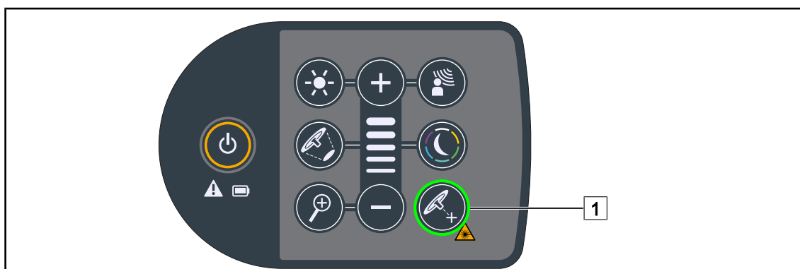
65 attēls: Pozicionēšanas palīglāzera aktivizēšana, izmantojot tastatūru
