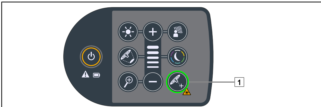
65 attēls: Pozicionēšanas palīglāzera aktivizēšana, izmantojot tastatūru
