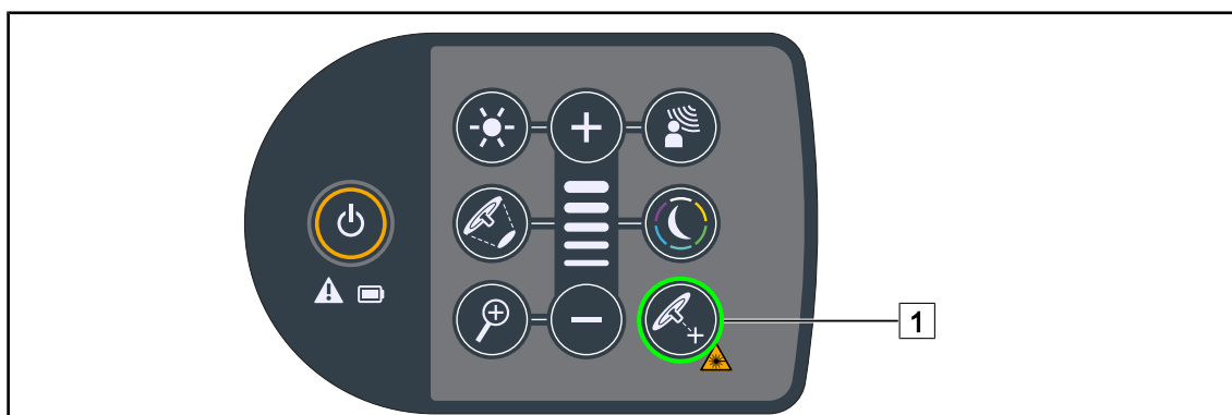
Fig. 65: Aktivering av positioneringshjälp med hjälp av laser via manöverpanelerna
