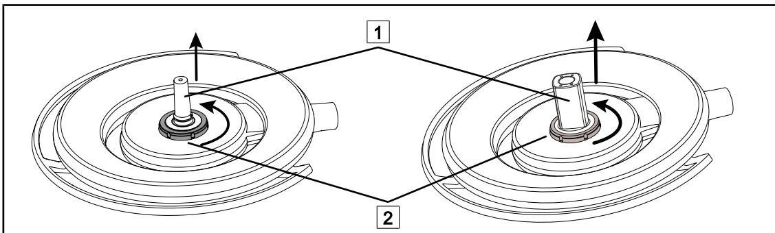
Sl. 86: Deinstalirajte uređaj Quick Lock +
