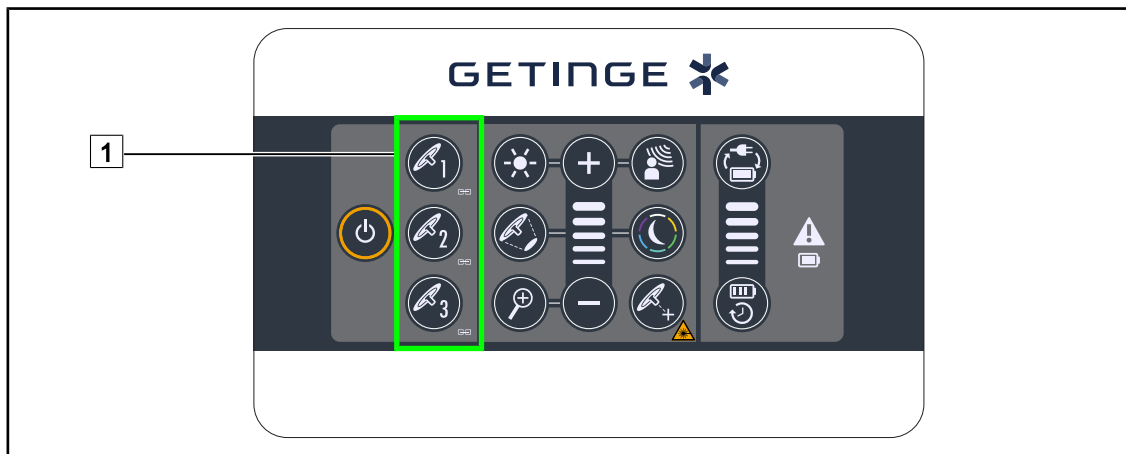
Fig. 59: Synkronisering af lampekuplerne ved hjælp af det vægmonterede panel
