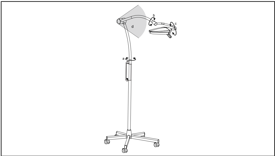
Fig. 20: Rotatiehoeken Lucea 40 verplaatsbaar model
