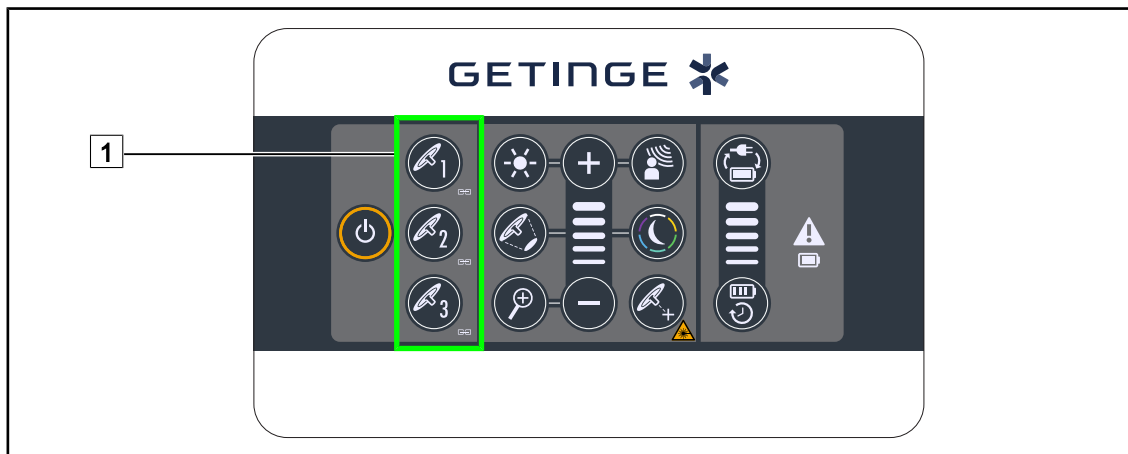
Kuva 59: Kupujen synkronoiminen seinään kiinnitetyn ohjauspaneelin avulla
