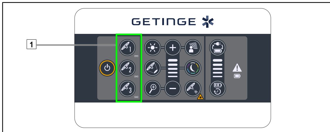
Fig. 60 : Synchronisation des coupoles via le clavier mural
