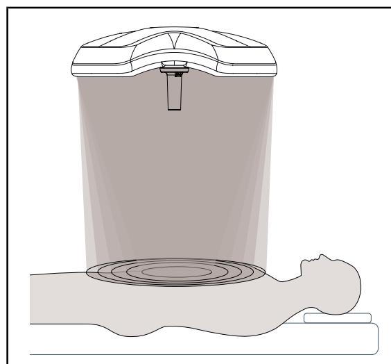
照射野径の調整により、術野の照射サイズを調整し、切開部と合わせることができます。Volista 照明システムでは5段階の調整が可能です。
