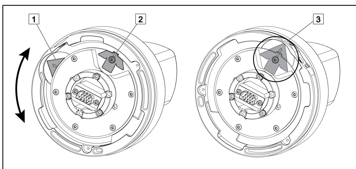
図 85: クイックロックシステムのカメラの事前ポジショニング
