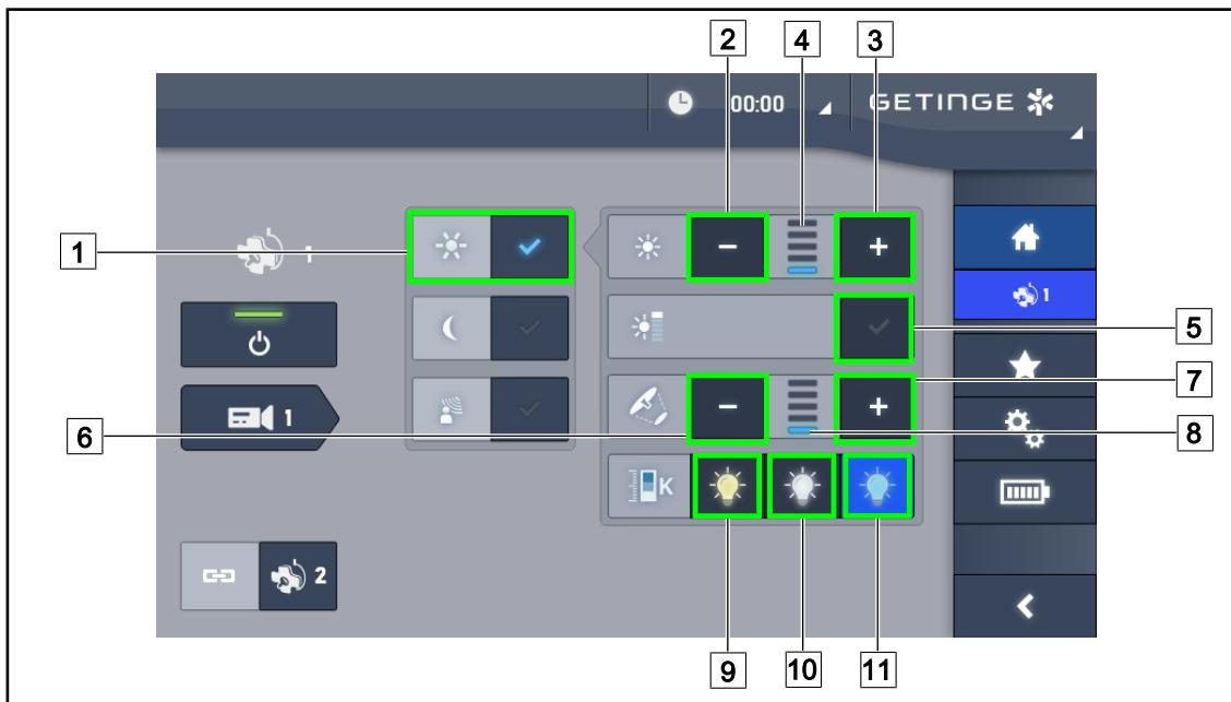
図 56: タッチスパネルを使用して照度を調整する
