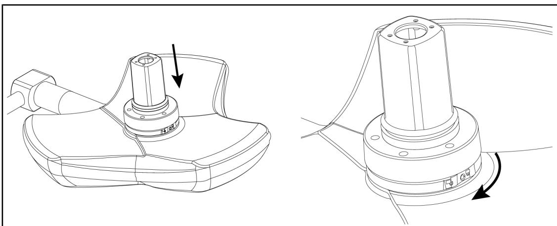
図 89: 灯体へのカメラの取り付け
