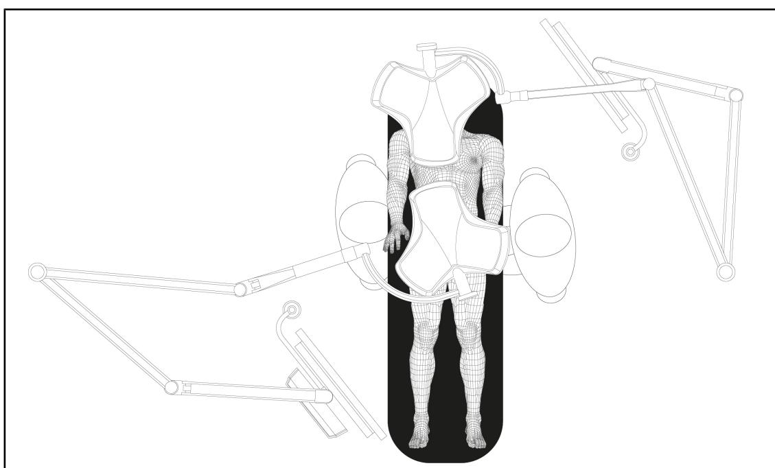
図 108: モニターサポート2基を使用したダブル構成の場合の事前ポジショニングの例
