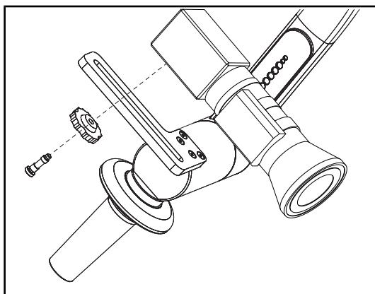
1. ネジを固定プレートの穴に差し込みます。
