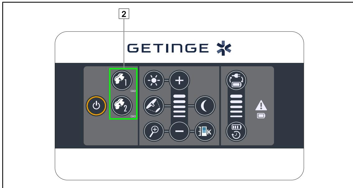
図 61: 壁のコントロールキーによる灯体の同期
