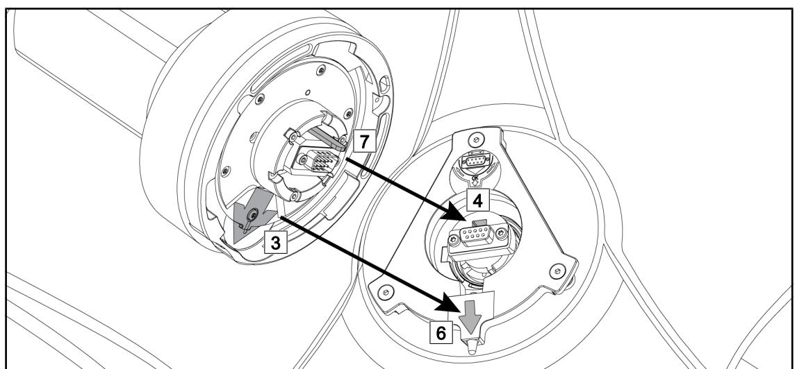
図 88: クイックロックシステムの取り付けに関する指示
