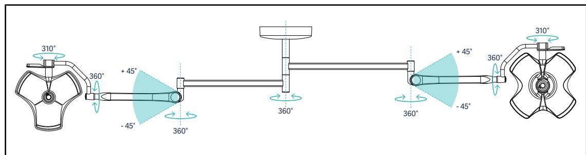
図 80: サスペンションSBを使用したダブル構成VCSII64SFの場合の可能な回転
