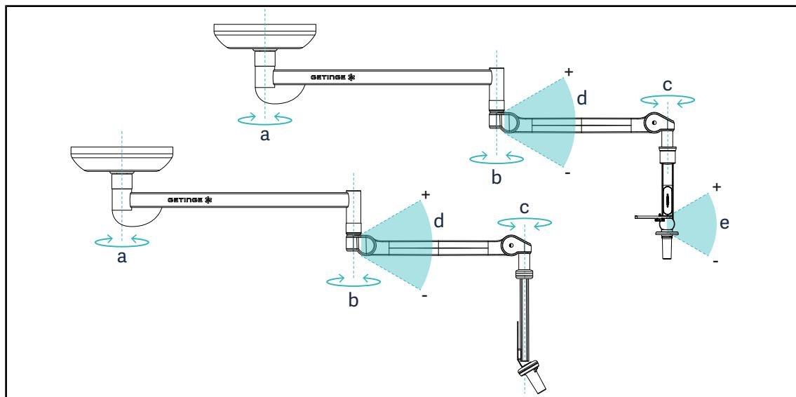
図 111: カメラサポートの回転角度
