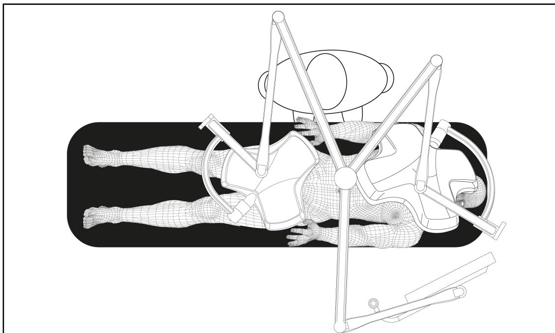
図 107: モニターサポートを使用したトリプル構成の場合の事前ポジショニングの例
