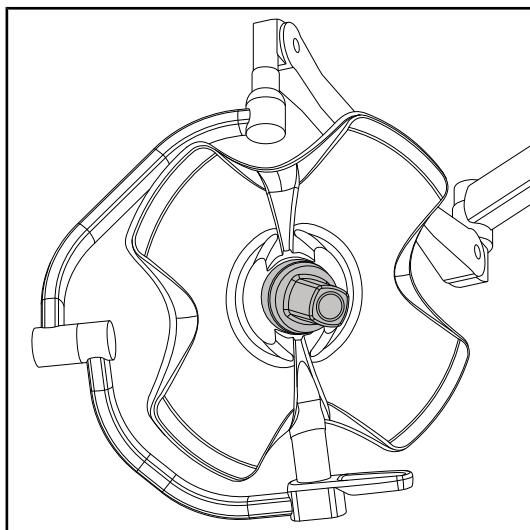
クイックロックシステムを使用して、カメラを灯体の中央に取り付けることができます。
