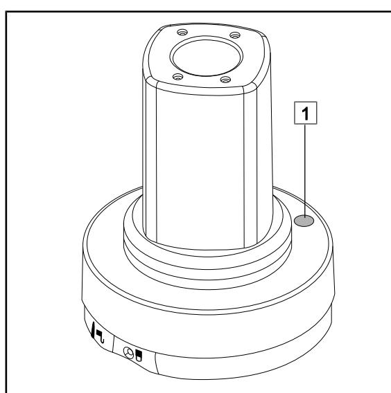
カメラとワイヤレスシステムのペアリングについては、ワイヤレスシステムに付属の製造元の使用説明書を参照してください。ペアリング操作中に、カメラ発信器のボタン（1）を押すと、信号検出段階でカメラの検出がスタートします。
