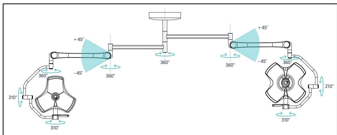
図 79: サスペンションSBを使用したダブル構成VCSII64DFの場合の可能な回転
