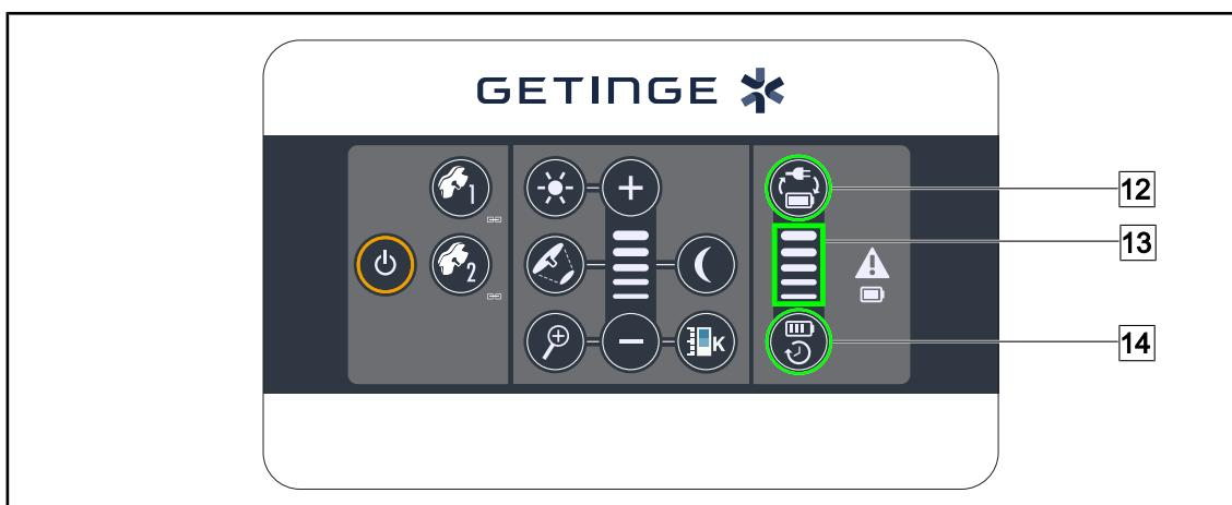
Fig. 122: Testare baterii de la tastatura murală
