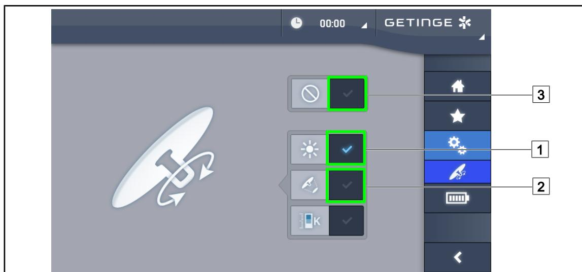
Рис. 119: Настройка параметров рукоятки Tilt
