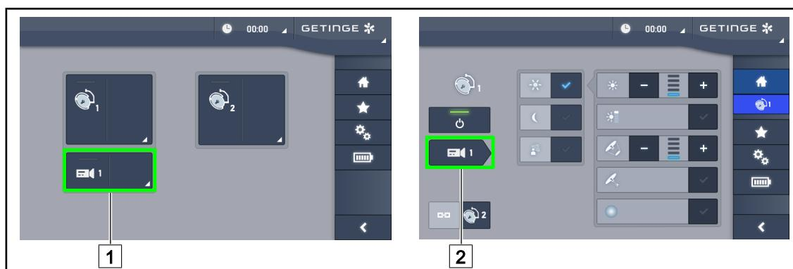
Рис. 94: Включение видеокамеры
