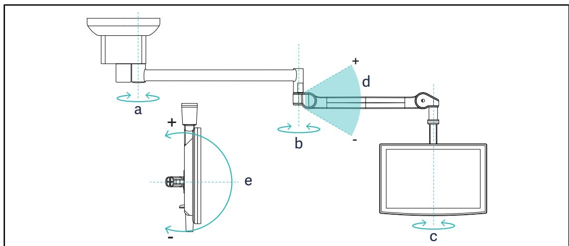
Рис. 109: Вращение возможно при использовании подвески SATX
