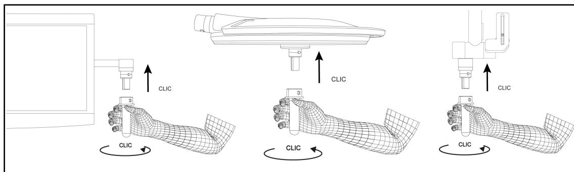
Рис. 66: Установка стерилизуемой рукоятки STG HLX 01
