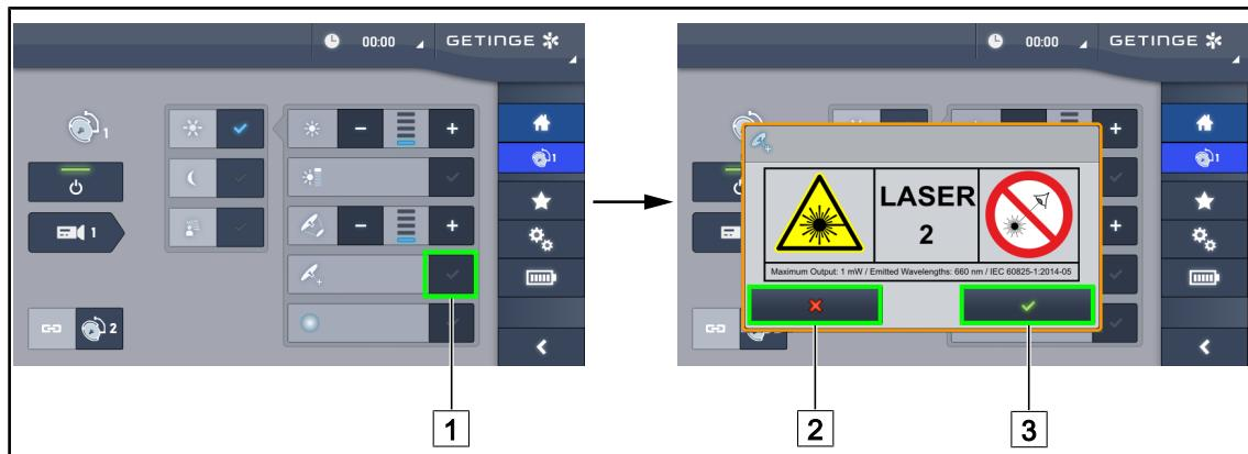
Рис. 79: Включение лазерного позиционирования с панели управления сенсорной
