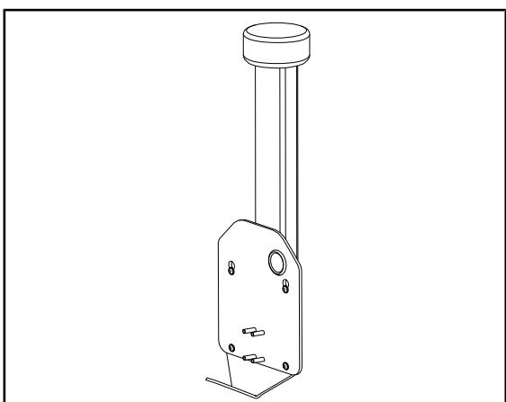
Пластину держателя для видеокамеры CAMERA HOLDER PLATE PSX/HLX/DAX FH можно установить на держателе для монитора FHS0 или MHS0. Этот держатель для камеры предназначен для установки медицинских видеокамер высокого разрешения, которые можно подключить к интерфейсу VESA 100 × 100. Камеру, установленную на этом держателе, можно установить в оптимальное положение для получения изображений операционной зоны под разными углами.
