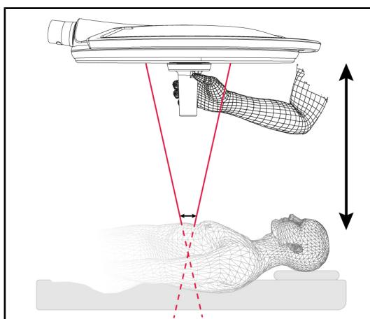
Для определения оптимального положения купола можно использовать функцию лазерного позиционирования (см. ниже). Для этого на уровне светового поля появляются две лазерные точки. Затем нужно опустить или поднять купол для того чтобы приблизить эти точки друг к другу.
