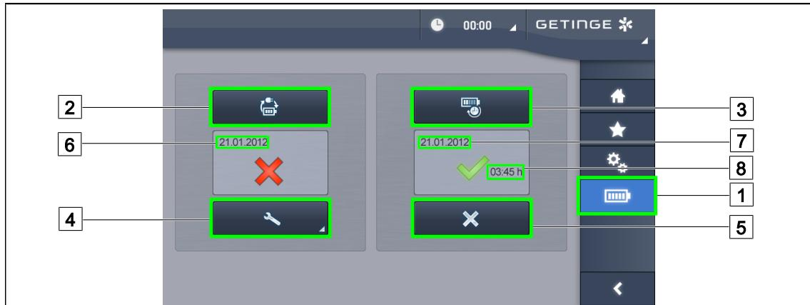
Рис. 123: Проверка аккумуляторов
