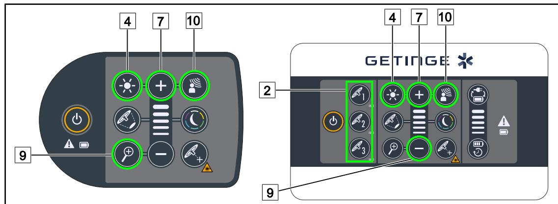
Рис. 56: Включение AIM с помощью кнопок управления
