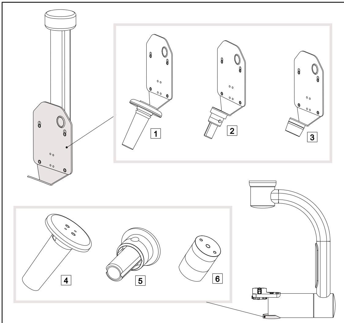
Рис. 20: Дополнительные принадлежности, предоставляемые с держателями камер
