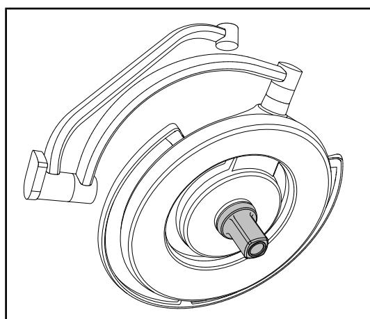
Видеокамера может быть установлена в центре купола с помощью механизма Quick Lock.
