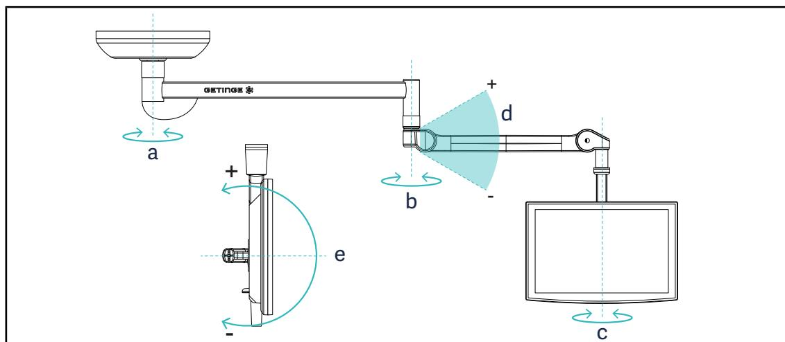
Рис. 108: Вращение возможно при использовании подвески SAX
