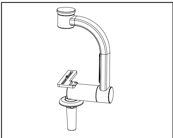
Этот держатель для видеокамеры предназначен для медицинских видеокамер высокого разрешения и передачи сложных сигналов благодаря большому диаметру. Видеокамера, установленная на этом держателе с помощью винта Kodak, вращается во всех направлениях для получения изображений операционной зоны под разными углами.
