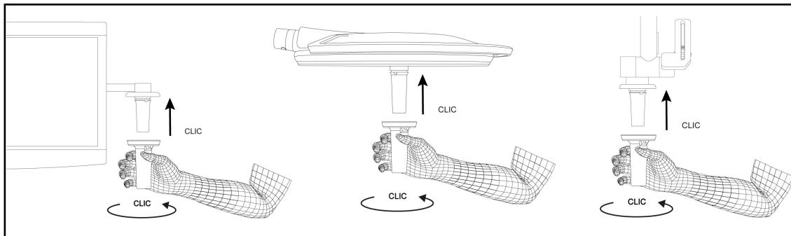
Рис. 64: Установка стерилизуемой рукоятки STG PSX 01
