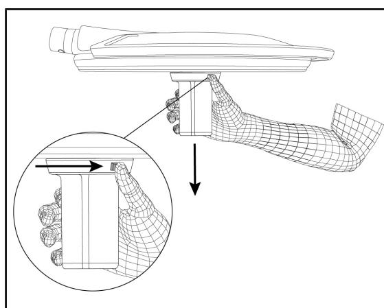
Рис. 71: Снятие стерилизуемой рукоятки STG PSX VZ 01
