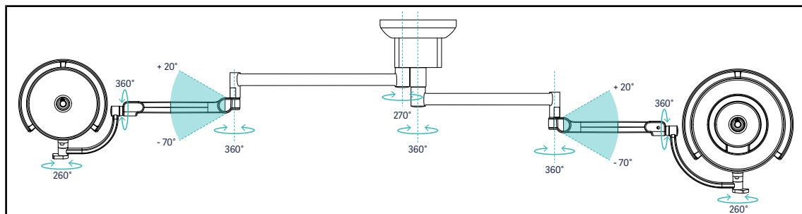
Рис. 75: Углы поворота с подвеской SATX и рычагом SF
