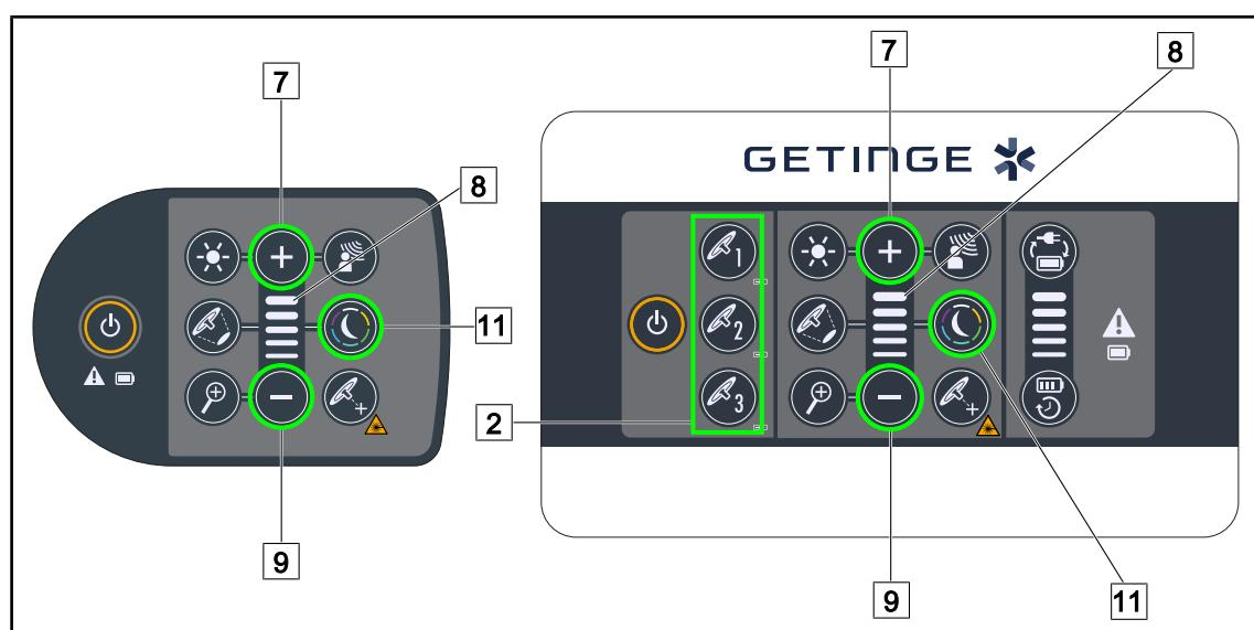
Рис. 54: Настройка фонового освещения с помощью панели управления
