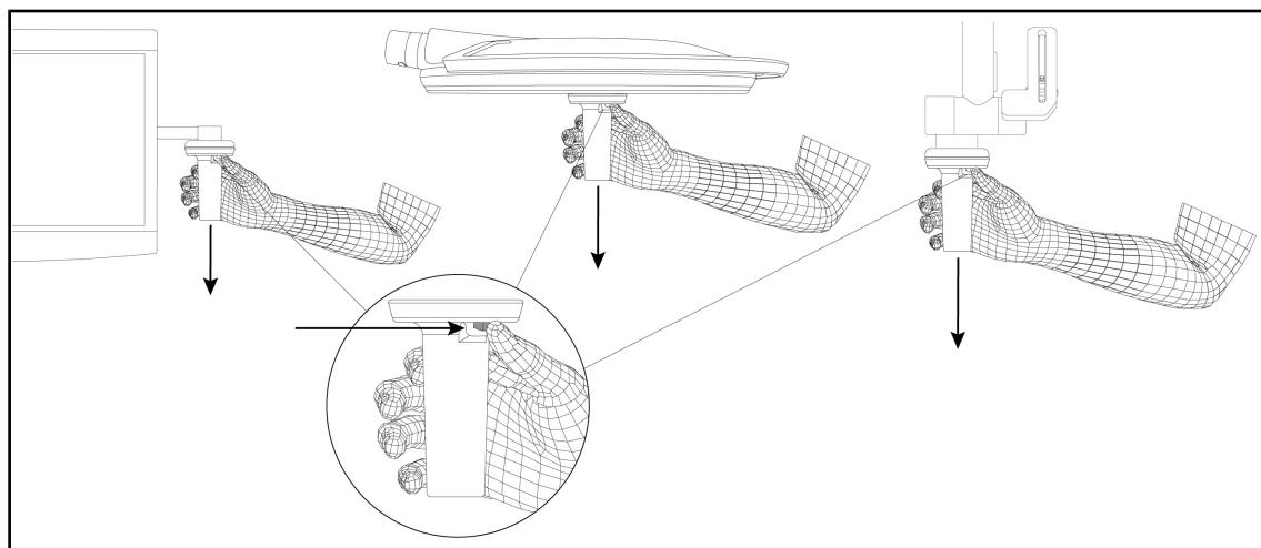
Рис. 65: Снятие стерилизуемой рукоятки STG PSX 01
