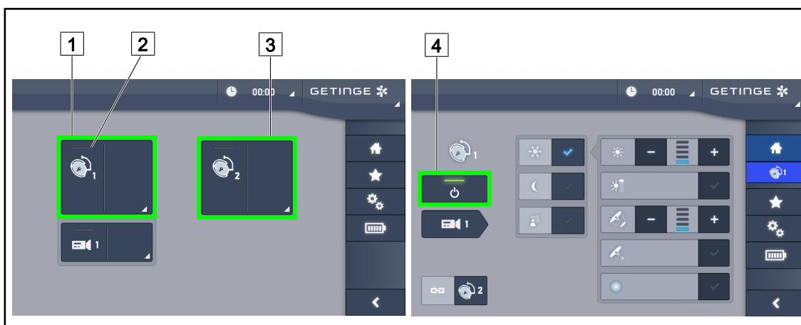
Рис. 51: Включение/выключение освещенности с помощью панели управления сенсорной
