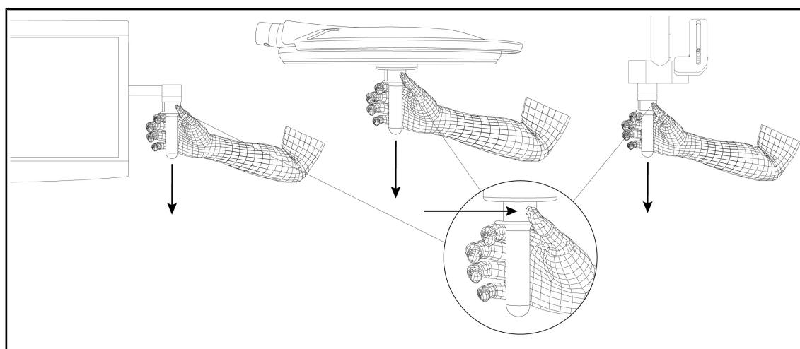
Рис. 67: Снятие стерилизуемой рукоятки STG HLX 01
