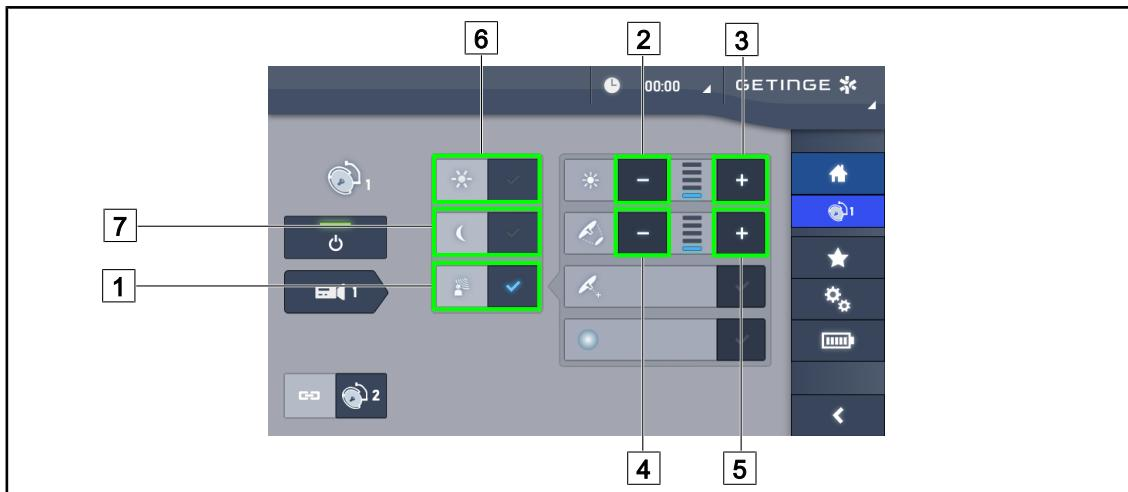
Рис. 57: Включение AIM с помощью сенсорной панели управления
