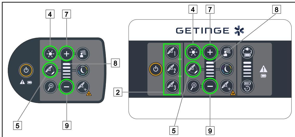
Рис. 52: Регулировка освещенности с помощью кнопочных пультов управления
