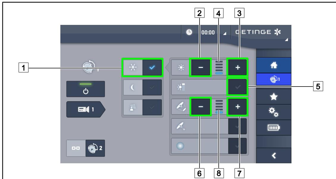
Рис. 53: Регулировка освещенности с помощью панели управления сенсорной
