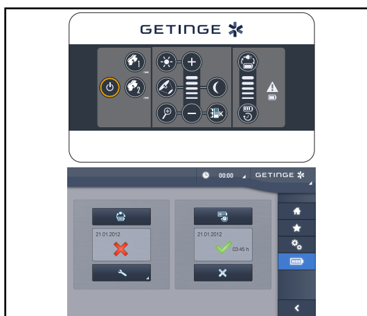
Рис. 52: Проверка переключения в режим работы от резервной системы
