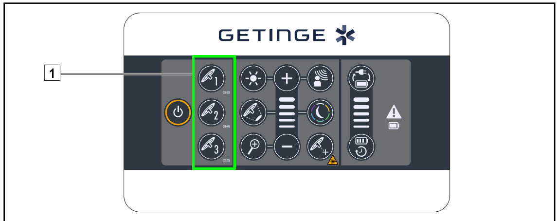
Obr. 60: Synchronizácia kupol pomocou nástennej klávesnice
