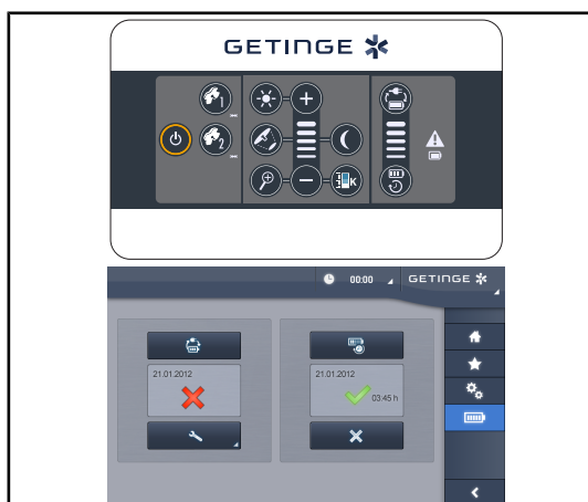
Obr. 52: Test prepnutia do núdzového systému
