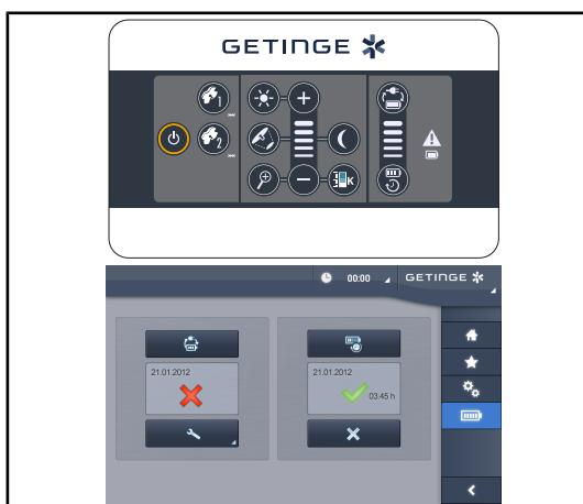
Obr. 52: Test prepnutia do núdzového systému
