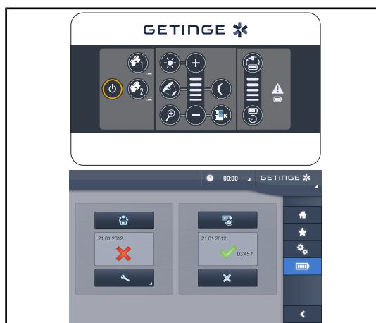
Sl. 52: Test samodejnega preklopa na pomožno napajanje (samo če je povezan sistem pomožnega napajanja)
