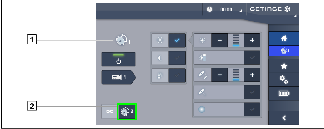
Şek. 61: Lamba başlıklarının senkronize edilmesi
