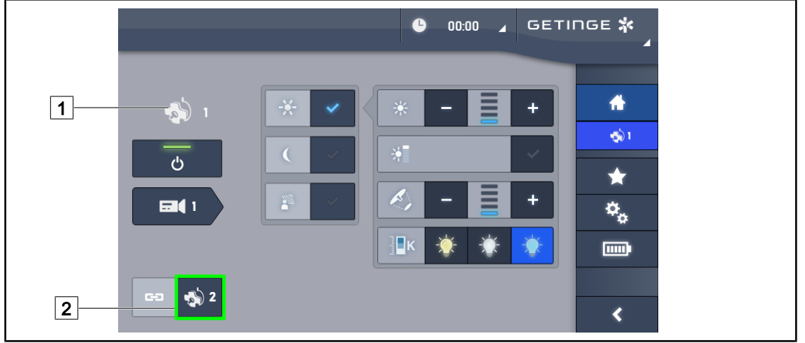
Şek. 62: Lamba başlıklarının senkronize edilmesi
