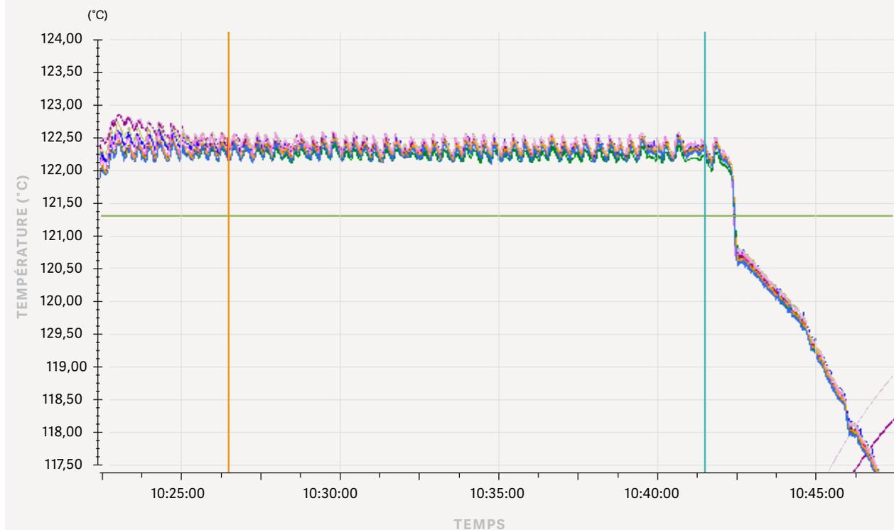
La cartographie par thermocouple a démontré des températures de stérilisation constantes dans les ensembles de filtres dans la plage autorisée de  $\pm 1$  K pendant la phase d'exposition. Un dépassement et un temps de maintien contrôlés garantissent une inactivation microbienne efficace sans surcharger la structure du filtre.
