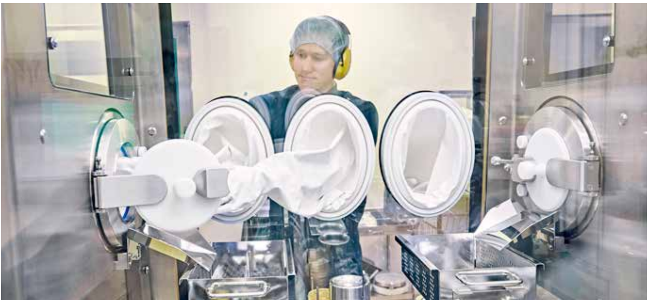
DPTE®-Komponententransfer an der SVP-Abfüllanlage von Octapharma in Stockholm
